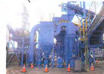
集塵機 粉塵を集めて大気汚染を防止する
