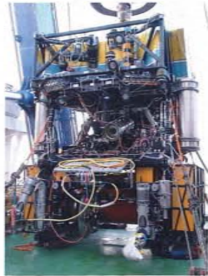
海底ケーブル展張装置（無人探査機搭載風景）
