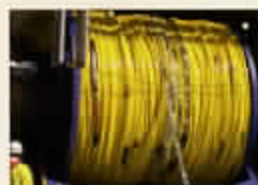
ストリーマーケーブル ハイドロフォン(受振器)を内蔵したケーブル。全長6Km
