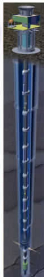
長期孔内計測システムイメージ
